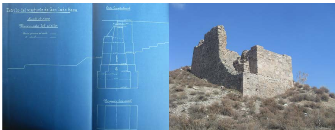
Figura 09: Proyecto de consolidación del estribo Baza. Archivo Histórico Ferroviario, signatura A-0159-001. Museo del Ferrocarril-Fundación de los Ferrocarriles Españoles. Fotografía del estribo en la actualidad, en la que se observa la materialización del proyecto.
